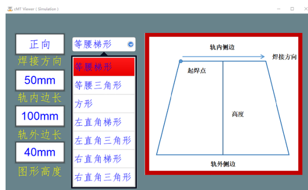
图4 HMI 焊接图形界面
